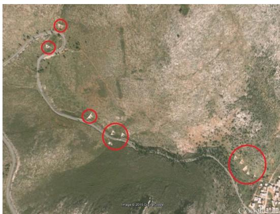
**Figura 6.11** Una serie de diques de cemento construidos montaña arriba por encima de Nea Makri unos meses después del incendio de 1995 en la montaña Penteli (Google Earth, 2004)
