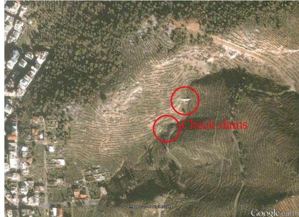
**Figura 6.6** Barreras de troncos en las laderas a lo largo del perímetro y dos diques de contención, construidos en un barranco después del incendio del 22 de julio de 1998 en la montaña Hymettus, cerca del suburbio de Kareas en Atenas, Grecia. Kareas se encuentra colina abajo del área quemada. El objetivo principal de la reconstrucción fue la prevención de la erosión y la protección ante inundaciones (Imagen de Google Earth, 2001).
