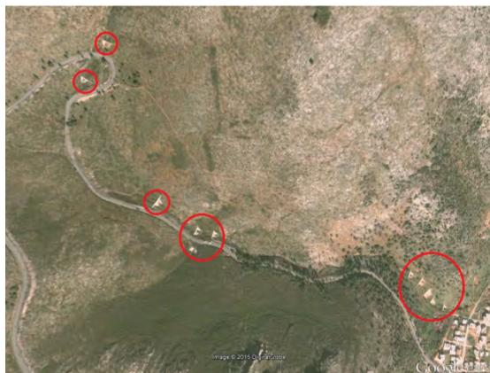
**Figura 6.11** Una serie di briglie in cemento costruite a monte della città di Nea Makri alcuni mesi dopo l'incendio del 1995 sul monte Penteli (Immagine di Google Earth 2004)
