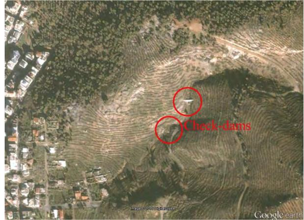
**Figura 6.6** Barriere di tronchi lungo i margini e due briglie, costruite in un impluvio dopo l'incendio del 22 luglio 1998 sul Monte Hymettus, vicino al villaggio di Kareas, Atene, Grecia. Kareas si trova a valle dell'area bruciata. L'obiettivo principale del ripristino era la prevenzione dell'erosione del suolo e delle alluvioni (Google Earth image, 2001).
