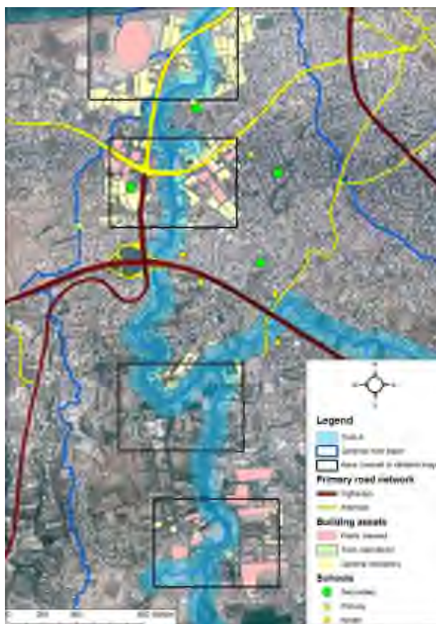
Фиг. 7.1.8 Карта на уязвимостта от наводнения в проучваната зона. (Източник: NHMC)
