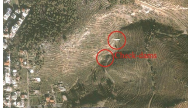
Εικόνα 6.6 Εμπόδια από κορμούς δέντρων στις πλαγιές κατά μήκος των ισοϋψών και 2 φράγματα αναχαίτισης, που κατασκευάστηκαν σε μια ρεματιά μετά τη φωτιά στις 22 Ιουλίου 1998 στο βουνό του Υμηττού. Ο Καρέας βρίσκεται κατάντη της καμένης περιοχής. Ο κύριος στόχος αποκατάστασης ήταν η πρόληψη της διάβρωσης του εδάφους και η προστασία από τις πλημμύρες (Google Earth image, 2001)
