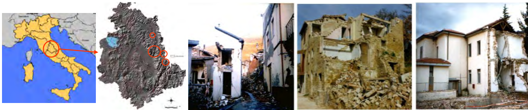
Εικ. 7.2.1 Επίκεντρα του κύριου σεισμού και των μετασεισμών που ακολούθησαν Εικ. 7.2.2 Κτίρια που υπέστησαν βλάβες από τον σεισμό στην Ούμπρια το 1997
