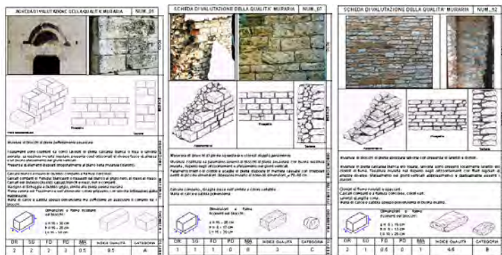
Εικ. 7.2.9 Πίνακες με τυπική τοιχοποιία στην Ούμπρια (Πηγή: Angeletti, Borri, Longhi, Nasini, Severi (2004), The law for seismic prevention in Umbria, Italy )
