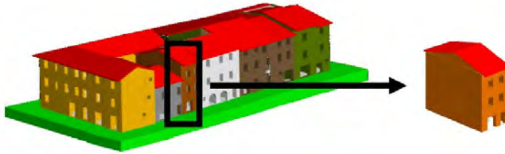
Εικ. 7.2.6 Ως συγκρότημα θα μπορούσε να οριστεί μια κατασκευή που οριοθετείται από ανοιχτούς χώρους (αριστερή εικόνα). Αποτελείται από Δομικές Μονάδες (Δ.Μ.) οι οποίες ορίζονται ως τμήματα του συγκροτήματος που έχουν ενιαία στατική και σεισμική συμπεριφορά.
